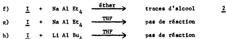
Ces résultats montrent le rôle déterminant du cation Li<sup>+</sup> ou Na<sup>+</sup> sur la vitesse de la réaction : lorsque le cation est solvatoé par des solvants basiques (éther, THF), la réaction n'a pas lieu ou est très fortement ralentie.
